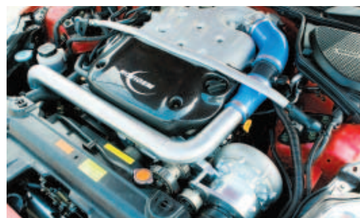
Le compresseur Novidem en position radiale (en bas à droite à l'image) se manifeste à l'oreille mais sans déranger.
